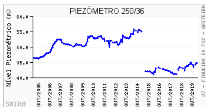
Figura 35: Evolução dos níveis piezométricos no piezómetro 250/36 do sistema aquífero O7 – Figueira da Foz - Gesteira.
